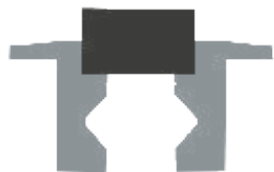
Découpe à 90° en haut pour serrage de fer plat à marquage ou poinçonnage central
